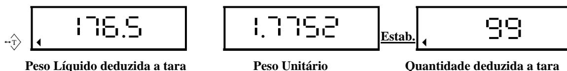
**Observação:** Para limpar da memória da balança um valor de pré-tara devemos remover todo material do prato de pesagem, de forma que o display de peso irá exibir um valor negativo. Pressionando a tecla “ T ” novamente o valor de tara será removido da memória da balança, a mesma irá indicar zero em seu display de peso e a legenda de tara será apagada.
